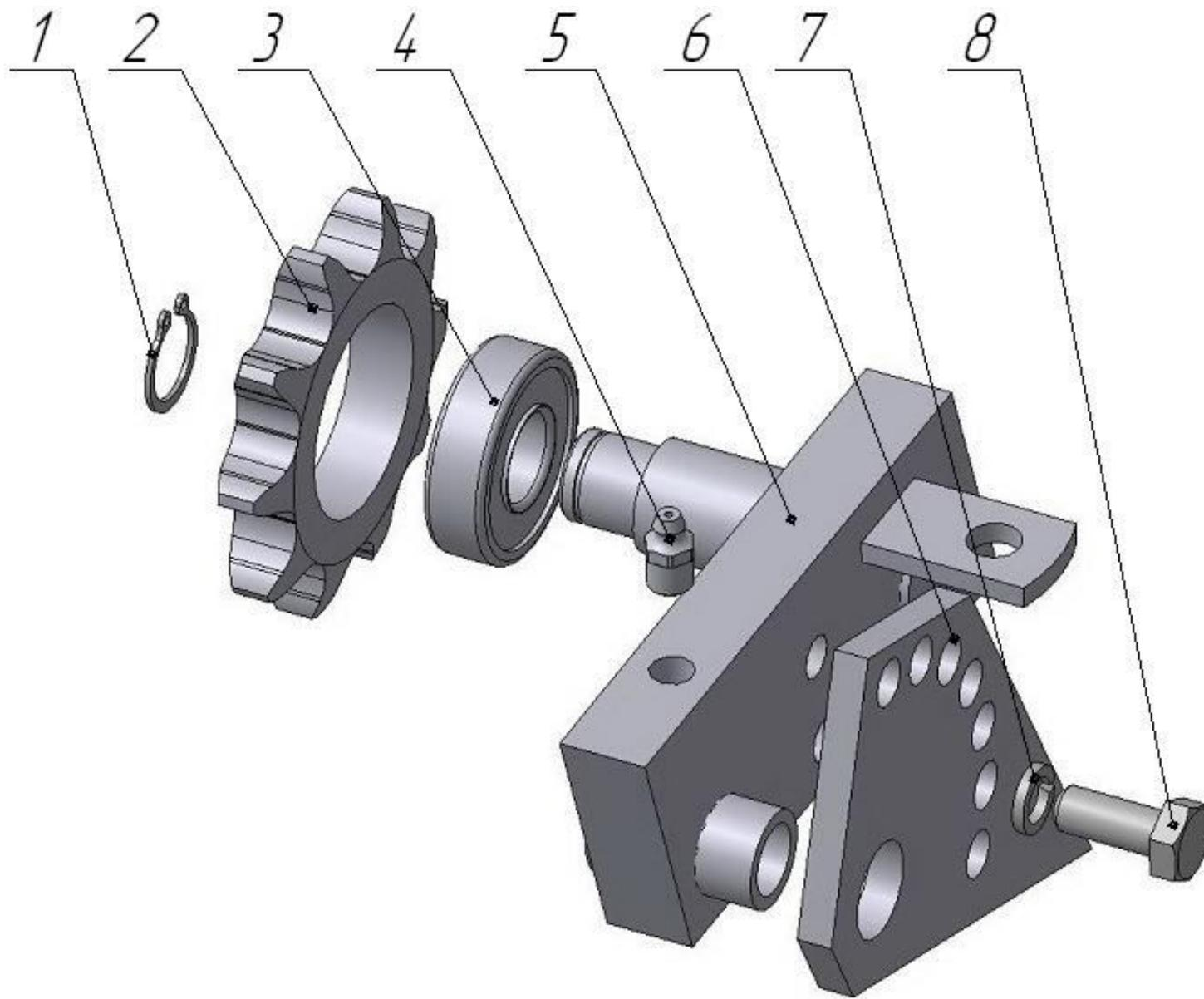
Рисунок 19 – Устройство натяжное
