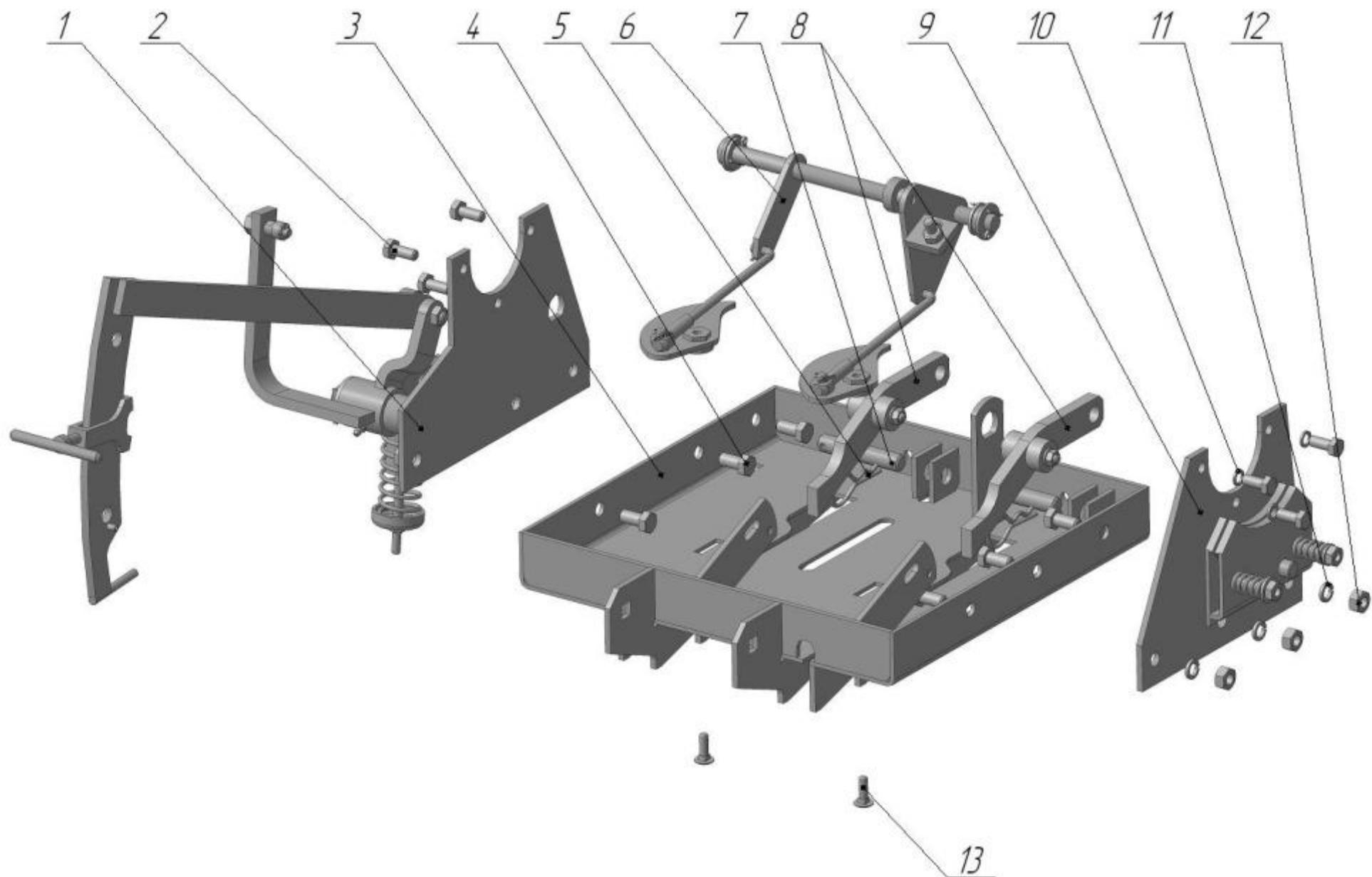
Рисунок 22 – Корпус стола вязального в сборе с рычагом привода задвижек
