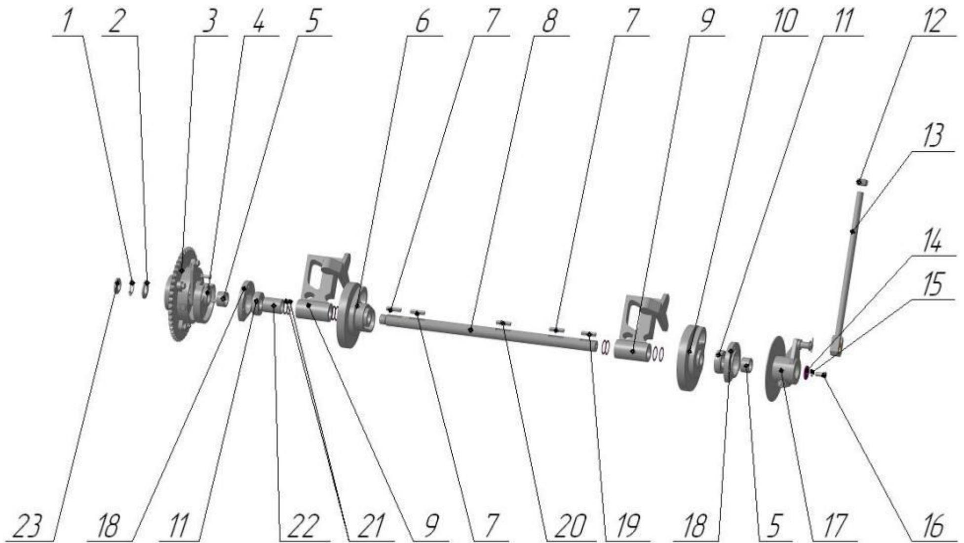
Рисунок 27 – Вал стола вязального в сборе
