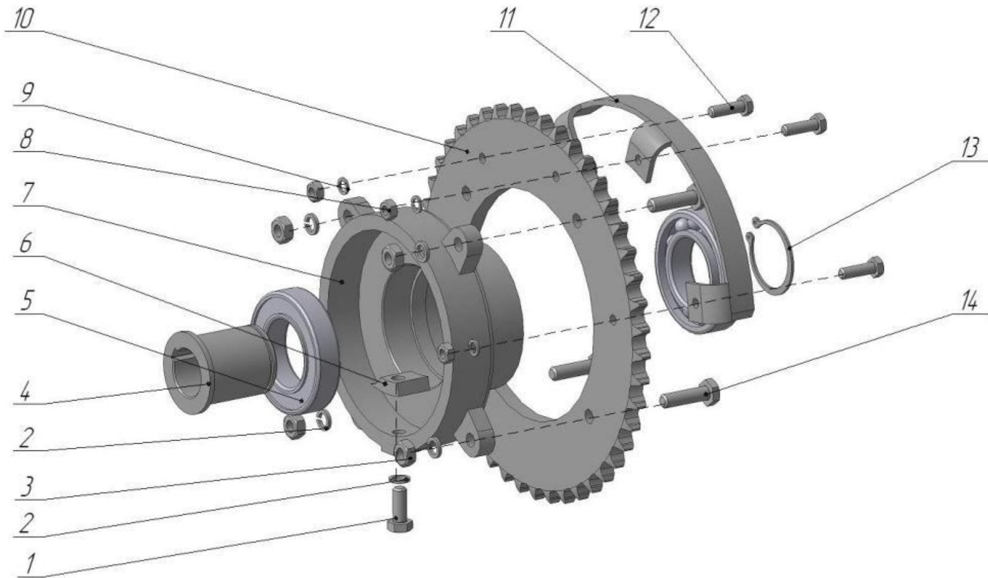
Рисунок 28 – Звездочка приводная
